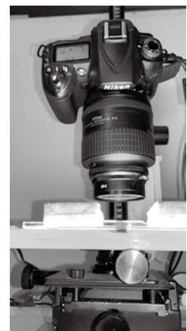
レンズが通常とは逆向きに取り付けられたカメラの様子
