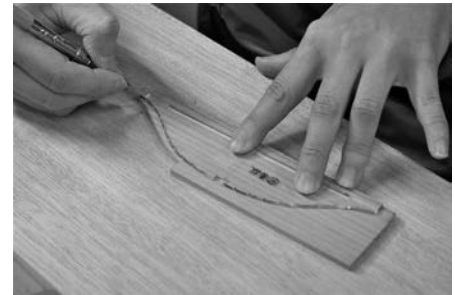
図3 アクリル板の型を使った妻板の墨付け
