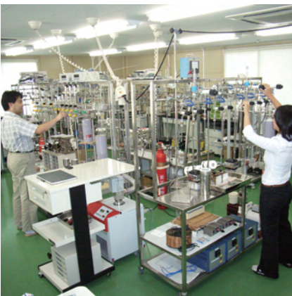
年代測定用の炭素を精製するための真空ライン装置
