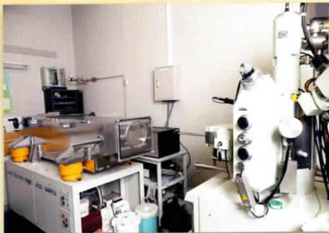
▲鉄炮分析用の大型試料室付(左)の走査型電子顕微鏡(右)
